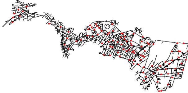
FIGURE 1 – *Les Fuites (en noir) et capteurs (en rouge) sur les tronçons du réseau de canalisations*
